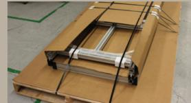
Los perfiles son cortados y maquinados, los sujetadores y accesorios se incluyen junto con la lista de partes, y el pedido completo es empacado y enviado para ser ensamblado en las instalaciones del cliente.
